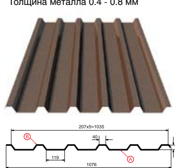
Профилированный лист МП-35х1035-А,В Толщина металла 0.5 - 0.9 мм
